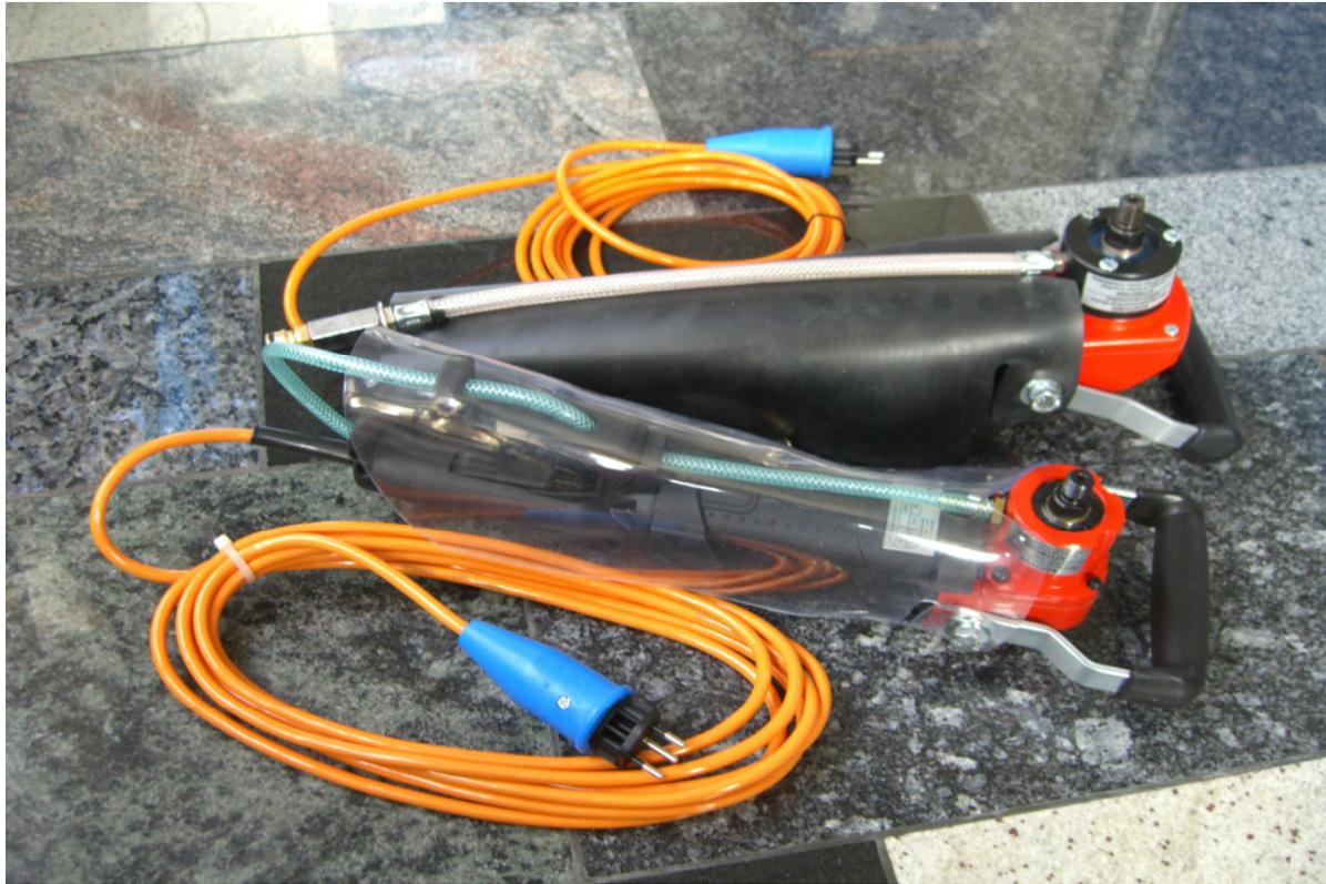
Mit zentraler Wasserzuführung zum Nassschleifen
